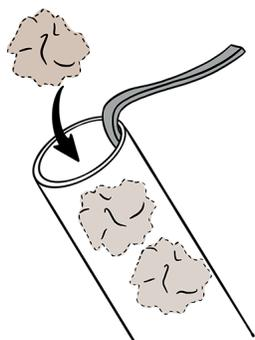
**A.** Hacer bolitas con cada una de las hojas de papel ignífugo e insertarlas dentro del fuselaje como se ve en la imagen (el número de bolitas depende del diámetro del fuselaje, ver tabla abajo). Así se protege el paracaídas de los gases calientes producidos por el motor al final de la combustión. El papel ignífugo no debe quedar ni muy holgado ni muy apretado dentro del tubo.
